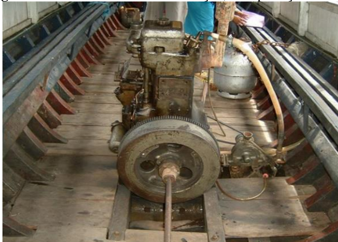
Figura 3: Eixo do motor de embarcação, sem proteção.
